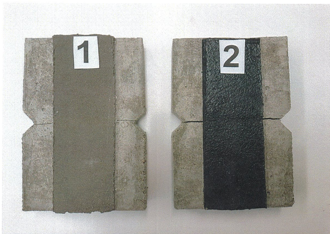
Рисунок 2 – Внешний вид бетонных образцов с системами покрытий на основе материалов Remmers для испытаний на трещиностойкость
